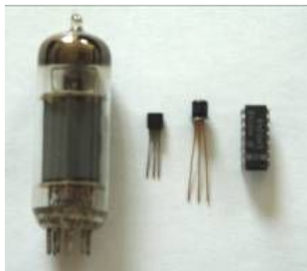
电子管、晶体管、集成电路比较
